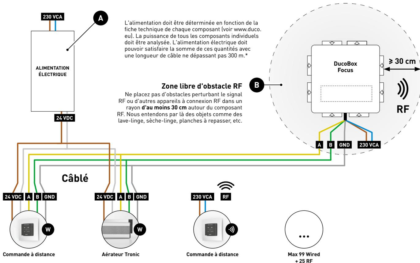
\* Utilisez un câble blindé à âme pleine d'une longueur maximale de 300 m, avec 5 fils de 0,8 mm<sup>2</sup>.
