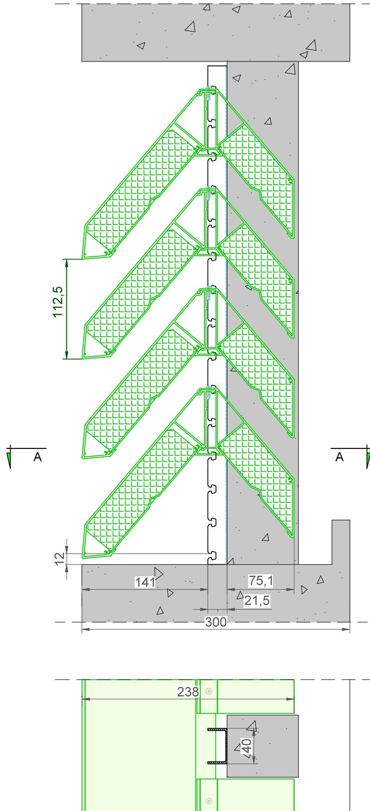
DucoWall Screening Acoustic **150+110/112** Draagprofiel 40/21 Dubbel
