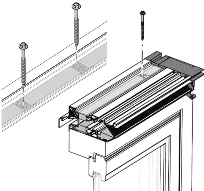
L'aérateur ne peut pas présenter de torsion sur le châssis. Ajustez au besoin le déroulement de l'aérateur jusqu'à ce qu'il soit parfaitement horizontal. Dans le cas contraire, Ducu ne garantit pas le bon fonctionnement de l'aérateur.
