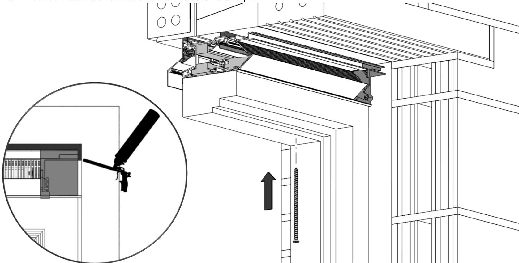
Parachevez l'intérieur. La partie amovible ne peut être ouverte ni retirée lors du ragréage. Évitez que du plâtre ne pénètre dans l'aérateur ! Le film de protection ne peut être ôté que lorsque le placement de l'aérateur est entièrement terminé.
