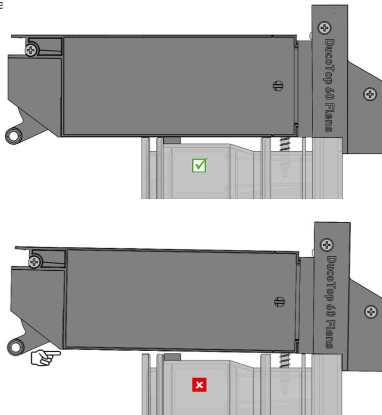
Percez par le haut à travers l'aérateur et le châssis à l'aide d'un **foret Ø 7**. Percez les trous tous les 750 mm au moins à travers les trous des raccords. Commencez toujours à la hauteur des raccords extérieurs et travaillez vers le centre.
