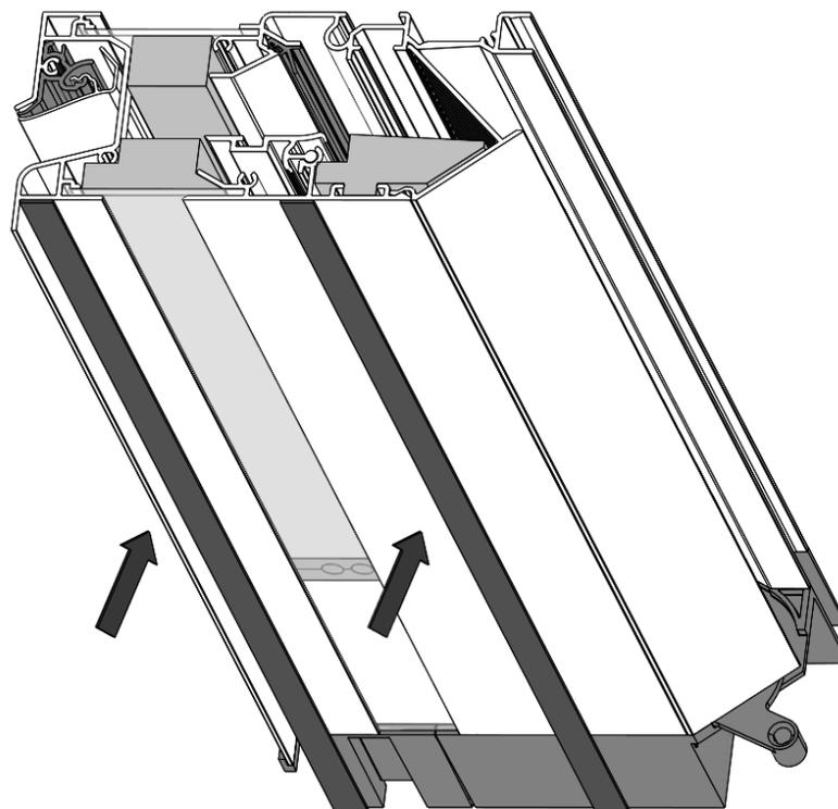
À l'aide d'un tendeur à vis aux extrémités, maintenez l'aérateur en place. Vissez ensuite l'aérateur à travers les trous préperçés **dans chaque raccordement** sur la fenêtre avec les vis fournies. Veillez à ce que les vis autotaraudeuses (DIN 7504K Ø6,3 x 80 mm) soient vissées avec un couple maximum de **3Nm**.
