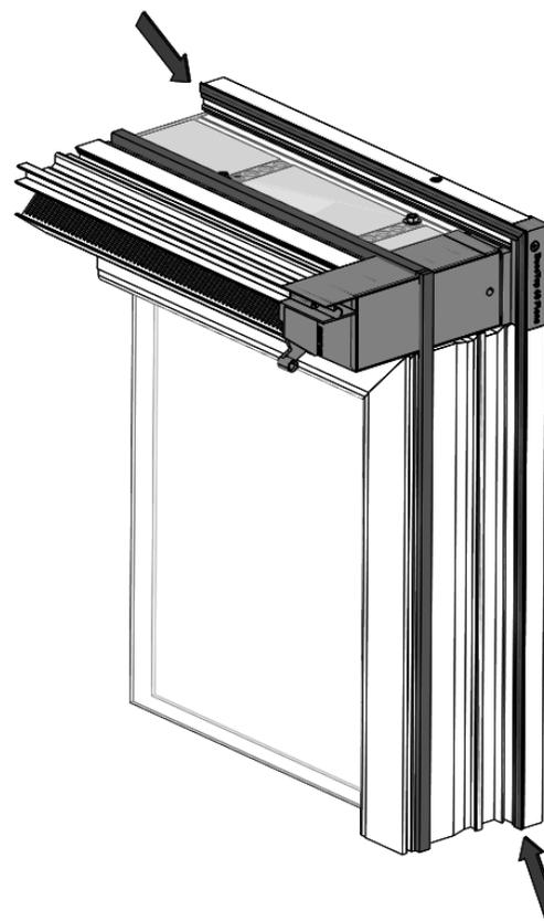
Faites basculer le châssis dans l'ouverture.
