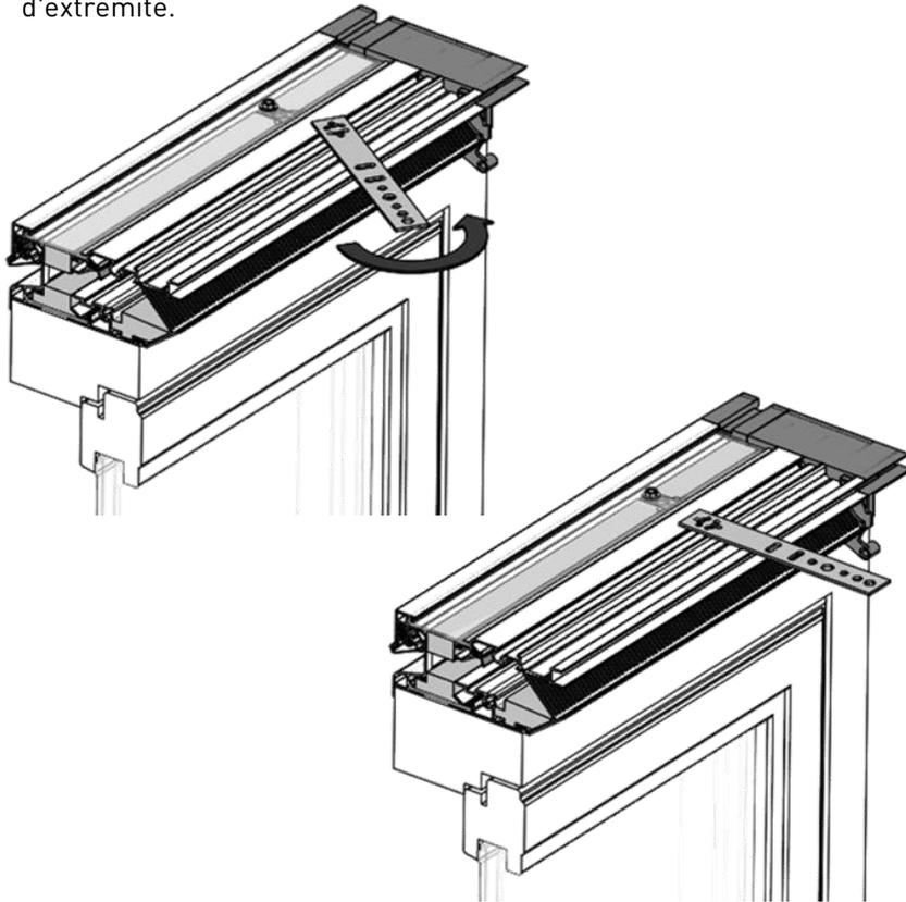
Si deux aérateurs doivent être connectés. Prenez une plaque d'assemblage de 91mm et appliquez de la colle à l'intérieur. Collez la plaque sur les côtés extérieurs entre les 2 aérateurs afin de couvrir le joint.
