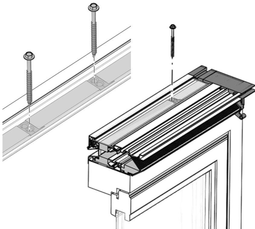
L'aérateur ne peut pas présenter de torsion sur le châssis. Ajustez au besoin le déroulement de l'aérateur jusqu'à ce qu'il soit parfaitement horizontal. Dans le cas contraire, Duco ne garantit pas le bon fonctionnement de l'aérateur.
