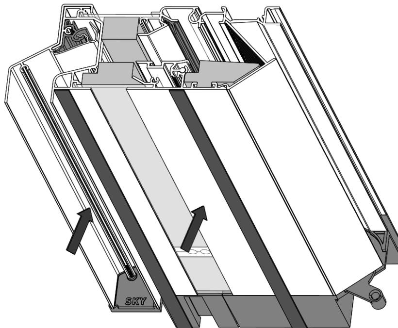
À l'aide d'un tendeur à vis aux extrémités, maintenez l'aérateur en place. Vissez ensuite l'aérateur à travers les trous prépercés **dans chaque raccordement** sur la fenêtre avec les vis fournies. Veillez à ce que les vis autotaraudeuses (DIN 7504K Ø6,3 x 80 mm) soient vissées avec un couple maximum de **3Nm**.
