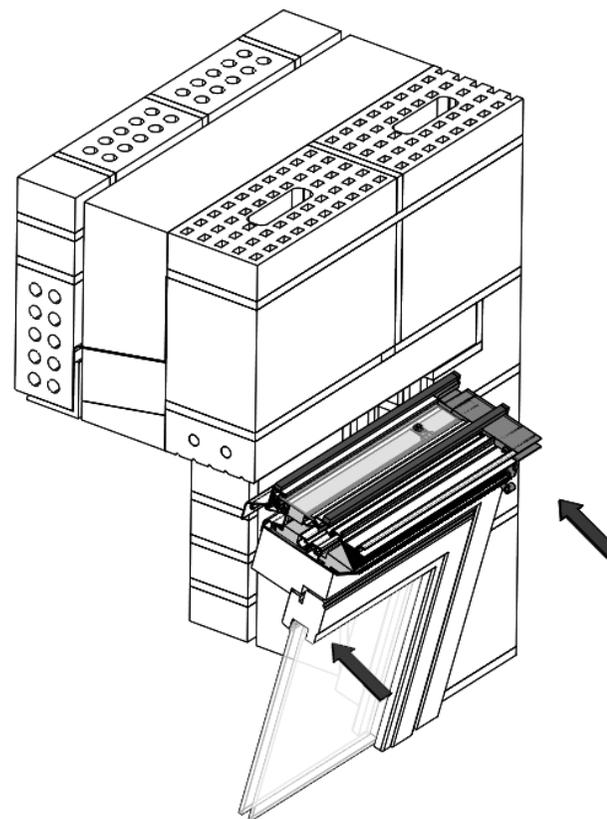
Alignez l'aérateur tous les 250mm . Fixez avec des vis Buildex depuis le dessous du châssis, à travers les raccords de l'aérateur, jusque dans la structure superposée. Veillez une fois encore à ce que l'aérateur ne présente aucune anomalie de torsion. Pulvérisez du PUR autour de l'ouverture afin de rendre l'ensemble complètement hermétique.
