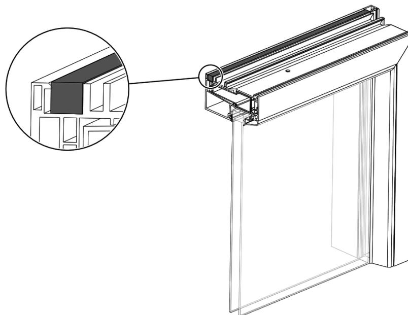
Collez un joint comprimable sur le côté supérieur de la fenêtre le plus loin possible, vers l'intérieur. L'épaisseur du joint comprimable dépend du type de fenêtre.
