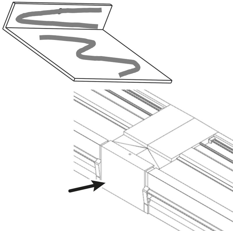
Collez le joint compribande (de préférence : joint compribande 15/2-6) sur la partie intérieure et extérieure, autour de la fenêtre et de l'aérateur au même endroit que le joint compribande entre la fenêtre et l'aérateur.
