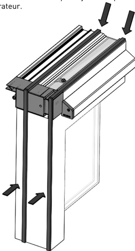
Dans le cas d'une finition Tronic, faites passer le câble par la conduite d'attente. Faites basculer le châssis dans l'ouverture.
