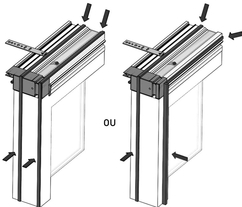
Dans le cas d'une finition Tronic, faites passer le câble par la conduite d'attente. Faites basculer le châssis dans l'ouverture.
