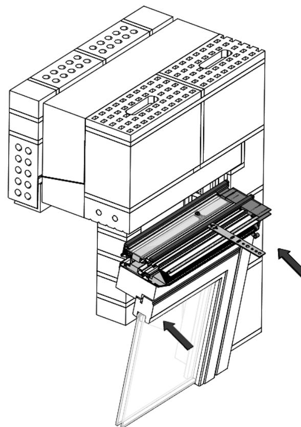
Aligner l'aérateur sur la construction superposée tous les 250mm. Fixez ensuite les ancrages à la construction (le type de fixation dépend de la construction). Veillez une fois encore à ce que l'aérateur ne présente aucune anomalie de torsion. Pulvérisez du PUR autour de l'ouverture afin de rendre l'ensemble complètement hermétique.
