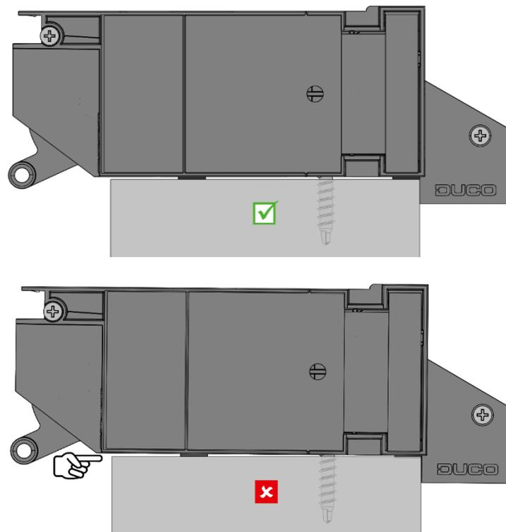
Percez par le haut à travers l'aérateur et le châssis à l'aide d'un foret  $\varnothing 7$ . Percez les trous tous les 750 mm au moins à travers les trous des raccords. Commencez toujours à la hauteur des raccords extérieurs et travaillez vers le centre.
