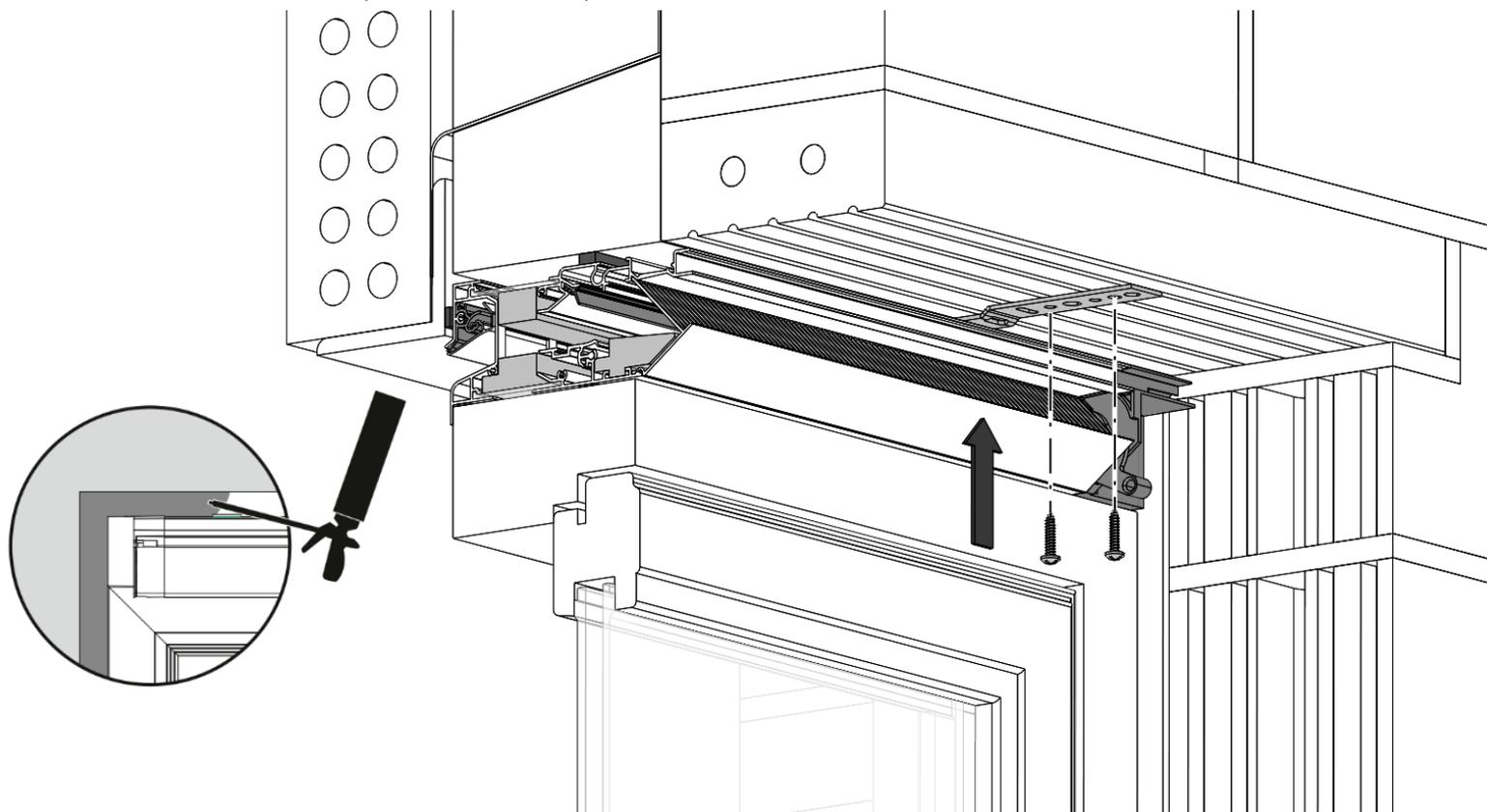
Parachevez l'intérieur. La partie amovible ne peut être ouverte ni retirée lors du ragréage. Évitez que du plâtre ne pénètre dans l'aérateur !
