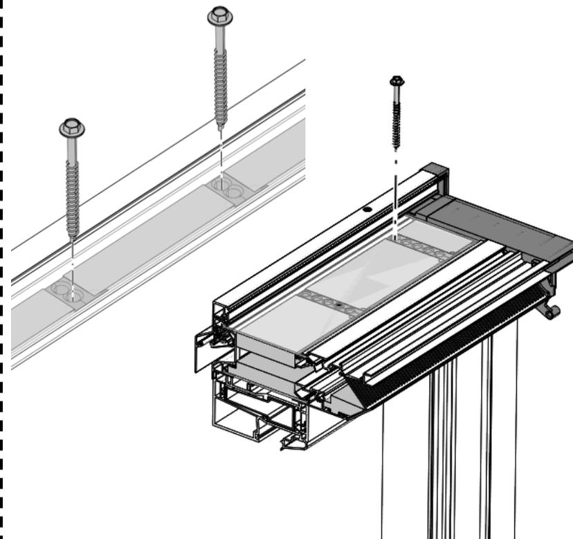
L'aérateur ne peut pas présenter de torsion sur le châssis. Ajustez au besoin le déroulement de l'aérateur jusqu'à ce qu'il soit parfaitement horizontal. Dans le cas contraire, Duco ne garantit pas le
