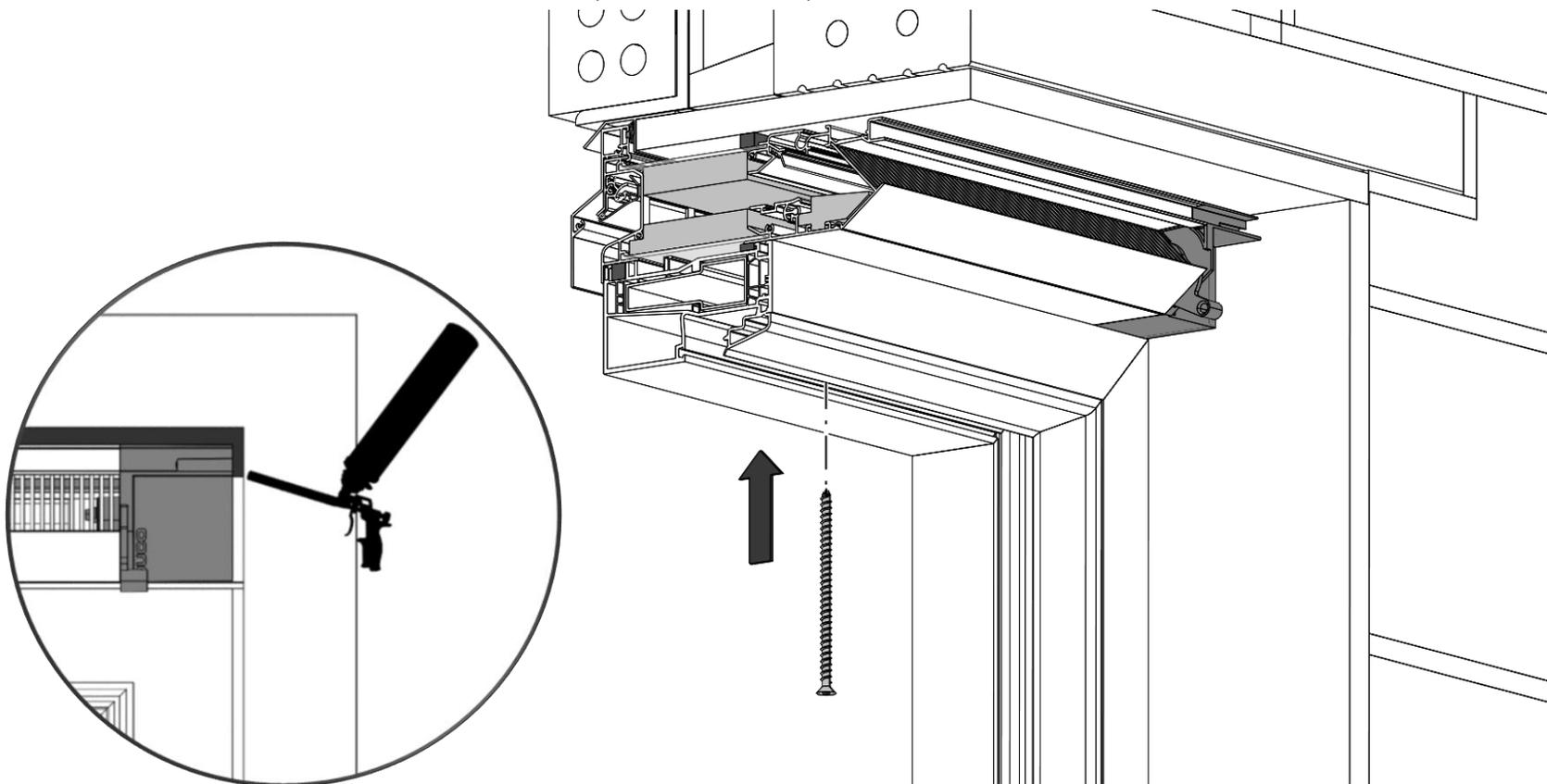
Parachevez l'intérieur. La partie amovible ne peut être ouverte ni retirée lors du ragréage. Évitez que du plâtre ne pénètre dans l'aérateur !
