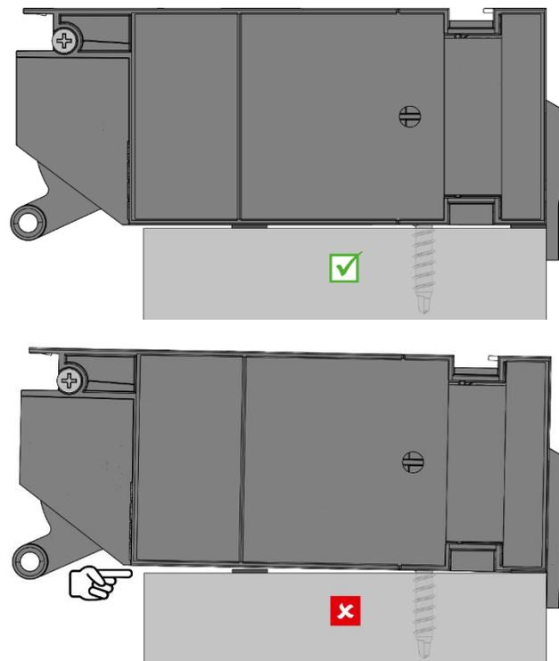
Vissez les goupilles en acier dans la gouttière d'ancrage de l'aérateur, à chaque fois à hauteur d'un raccord. Positionnez-les à un **intervalle max. de 750 mm**, en commençant au niveau du raccord d'extrémité.
