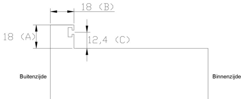
Le côté supérieur du châssis doit toujours être conçu sans butée afin que la bride TopVent puisse être placée à fleur de fenêtre.
