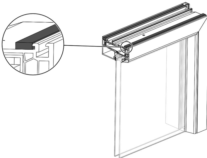
À l'aide d'un tendeur à vis aux extrémités, maintenez l'aérateur en place. Vissez ensuite l'aérateur à travers les trous prépercés **dans chaque raccordement** sur la fenêtre avec les vis fournies. Veillez à ce que les vis autotaraudeuses (DIN 7504K Ø6,3 x 80 mm) soient vissées avec un couple maximum de **3Nm**.
