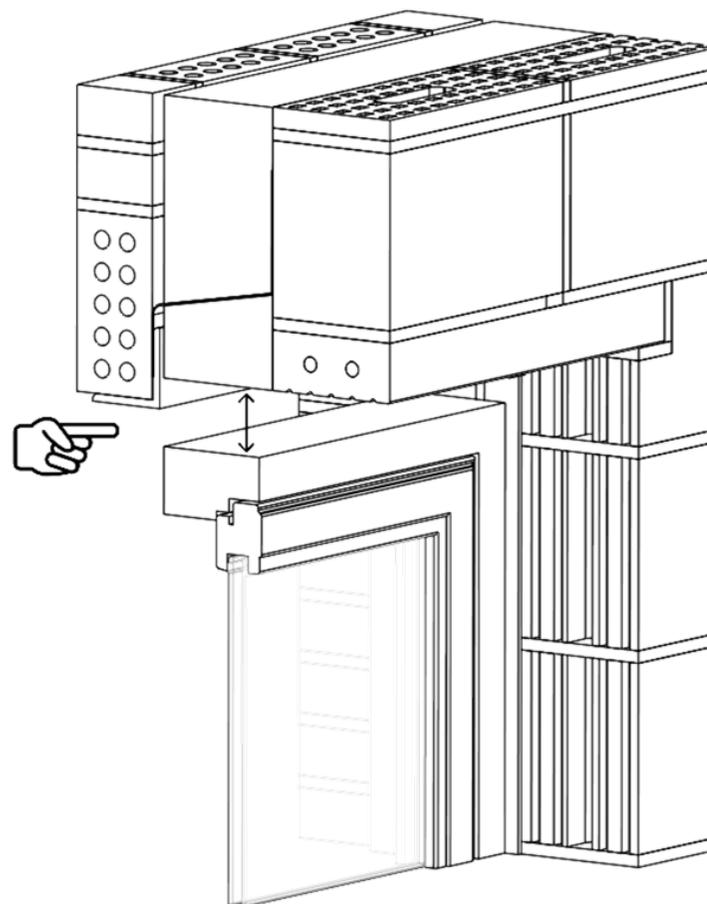
Pour chaque raccordement, percez un trou à travers l'aérateur en partant du haut et **à travers le trou du raccordement** aux endroits où l'aérateur sera fixé à la fenêtre. Utilisez pour ce faire un **foret d'un Ø de 7 mm**. **Orientez les trous vers les positions extrêmes** ou éloignés le plus possible les uns des autres si la fenêtre n'autorise pas de positions extrêmes.
