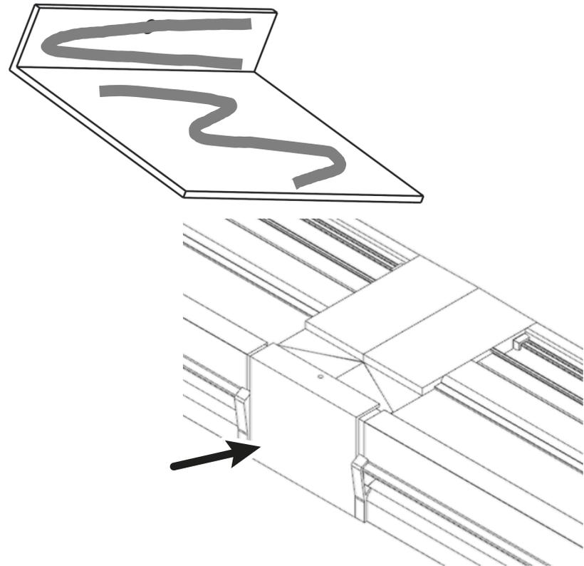
Collez le joint compribande (de préférence : joint compribande 15/2-6) sur la partie intérieure, autour de la fenêtre et de l'aérateur au même endroit que le joint compribande entre la fenêtre et l'aérateur. Collez un 2<sup>ème</sup> joint compribande à l'extérieur ou autour de la fenêtre et de l'aérateur, ou à l'extérieur (lorsque la fenêtre et l'aérateur se trouvent derrière la course).
