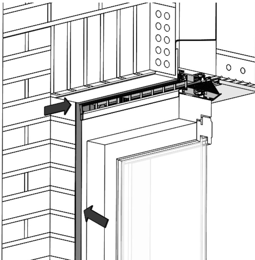
Pour chaque raccordement, percez un trou à travers l'aérateur en partant du haut et **à travers le trou du raccordement** aux endroits où l'aérateur sera fixé à la fenêtre. Utilisez pour ce faire un **foret d'un Ø de 7 mm**. **Orientez les trous vers les positions extrêmes** ou éloignés le plus possible les uns des autres si la fenêtre n'autorise pas de positions extrêmes.
