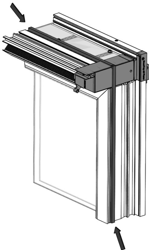
À l'extérieur, placez le caoutchouc autour de la fenêtre et l'aérateur dans l'ouverture prévue à cet effet. Il s'agit du caoutchouc qui est livré avec la fenêtre.
