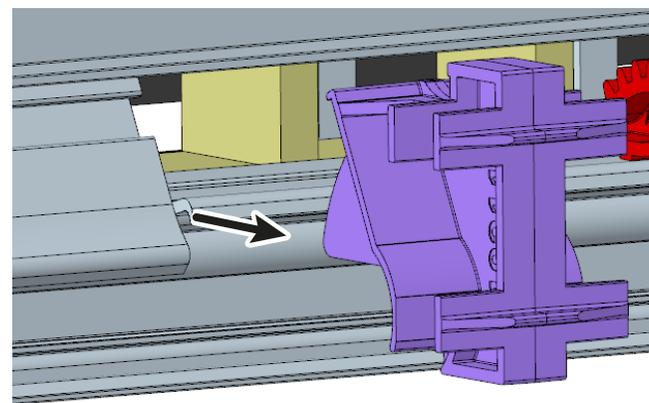
Si nécessaire, retirez les pièces de blocage de clapet.
