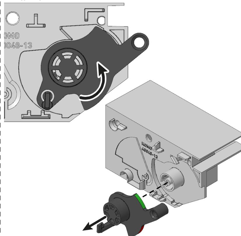
Tournez le clapet vers le haut jusqu'à ce qu'il soit presque vertical. Poussez ensuite le clapet vers le haut.
