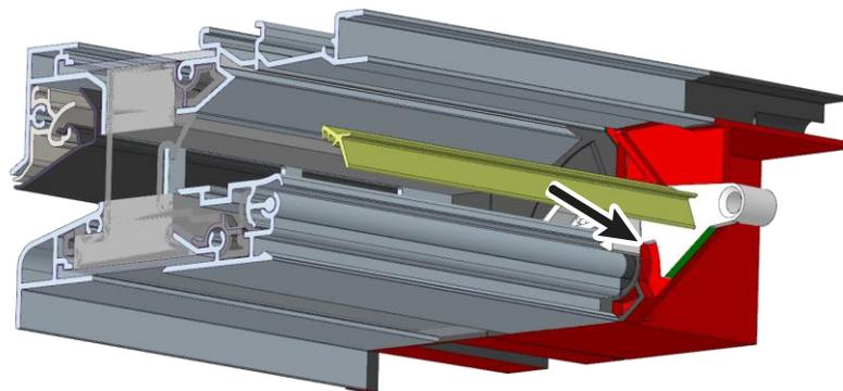
Dans le cas de TopVent Medio, Alto ou Largo, alignez la clapet de manière à ce que la pièce de commande de clapet puisse glisser sur la
