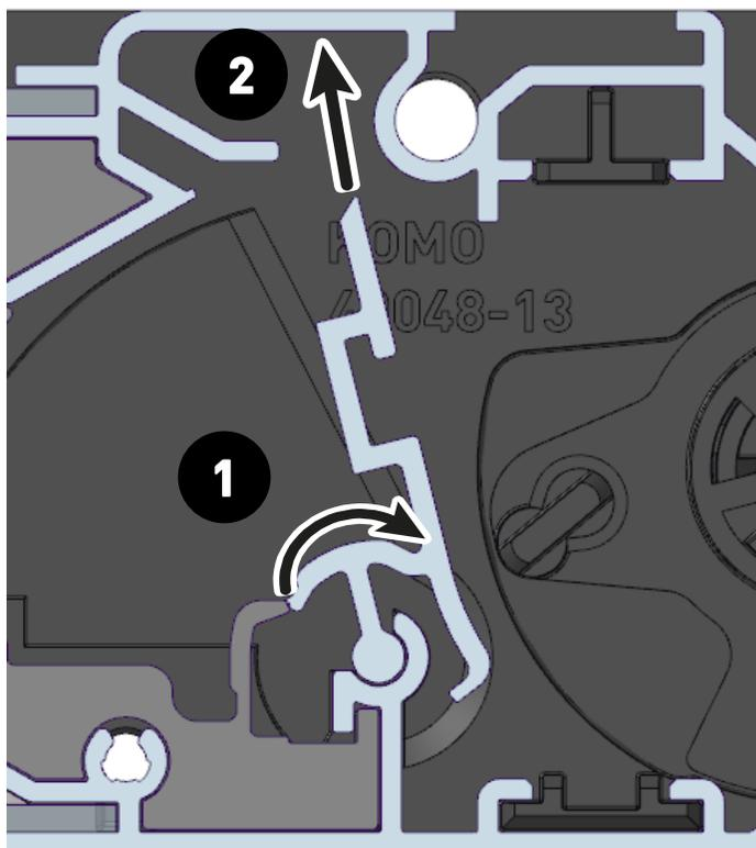
Le clapet peut ensuite être retiré de l'aérateur à l'avant.
