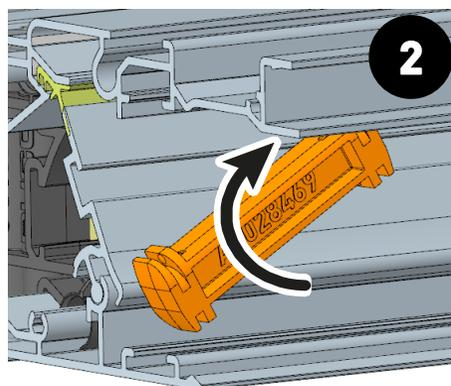
Si nécessaire, retirez les pièces centrales de clapet.
